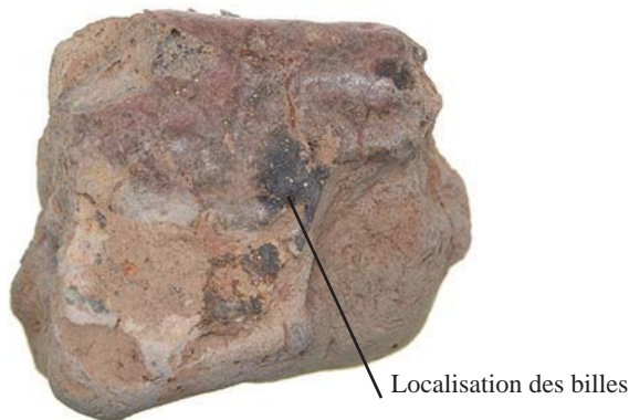
Fig. 4 : Fragment de creuset (Motteville). Éch. 1:1
