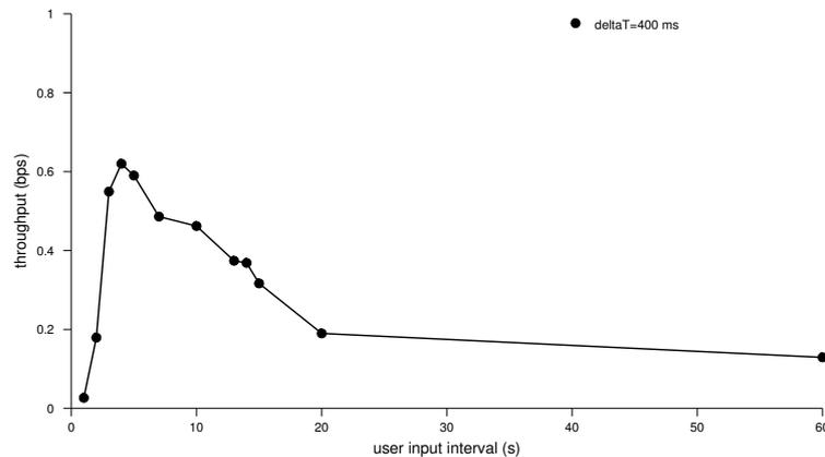
FIGURE 4.5 – Bande passante de CC#2 en fonction des interactions utilisateur et pour  $\Delta T = 400 \text{ ms}$
