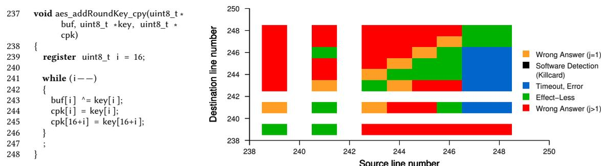
FIGURE 3.5 – Evaluation des conséquences des attaques par saut sur la fonction `aes_addRoundKey_cpy`
