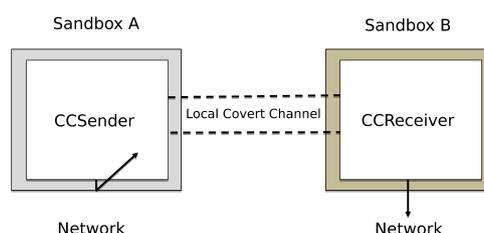
FIGURE 4.2 – Canal auxiliaire entre deux applications locales
