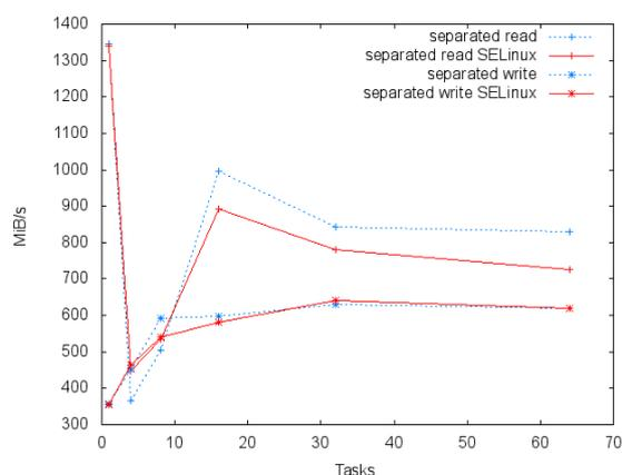
FIGURE 2.7 – Impact sur les entrées/sorties MPI
