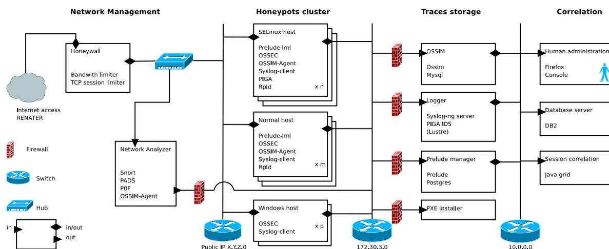
FIGURE 2.2 – Architecture d'un pot de miel hautes interactions
