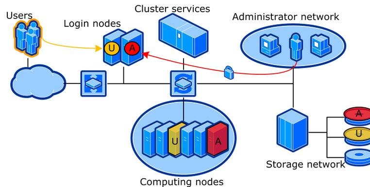
FIGURE 2.5 – Différents accès suivant les utilisateur projetés dans différents conteneurs
