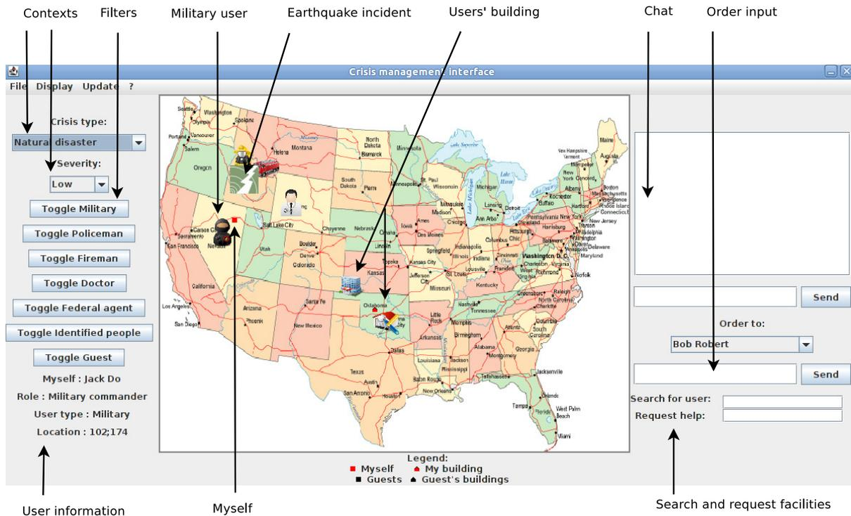
FIGURE 2.9 – Interface du logiciel de gestion de crise
