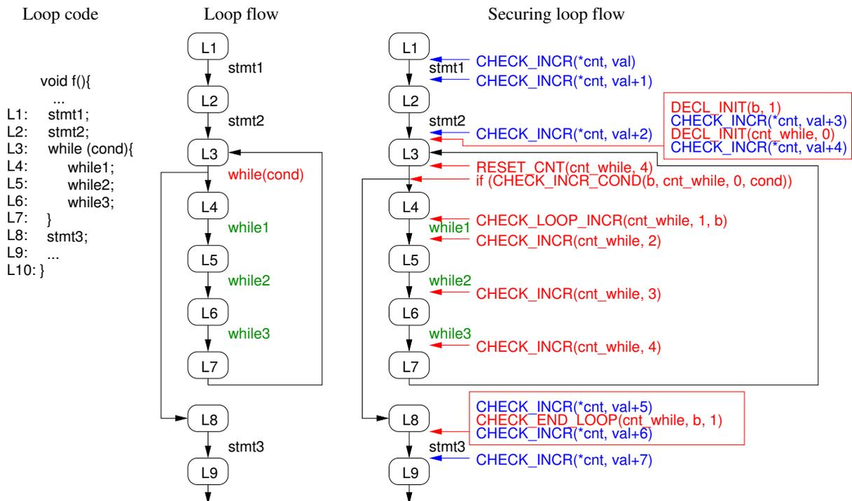
FIGURE 3.9 – Sécurisation d'une boucle
