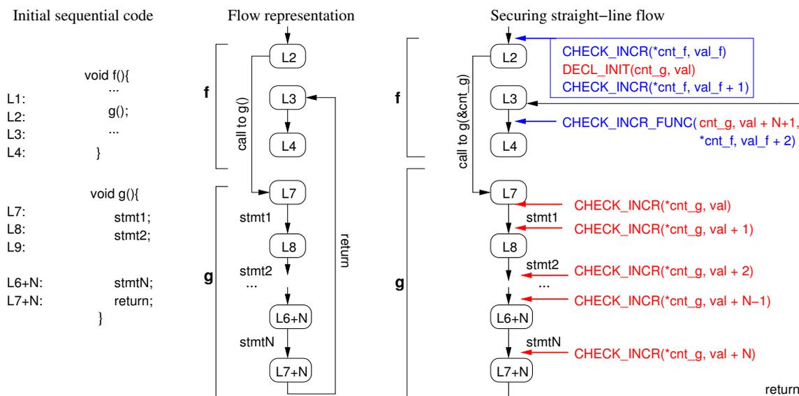
FIGURE 3.6 – Sécurisation d'instructions séquentielles et d'appels de fonctions
