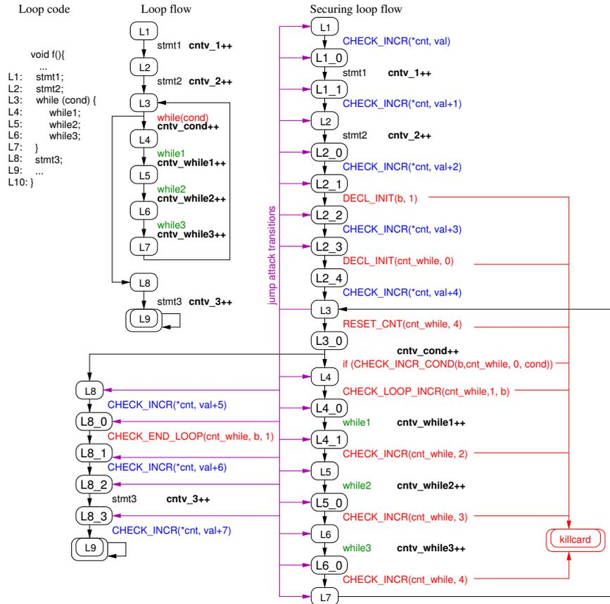
FIGURE 5.3 – Représentation compacte de TS pour une boucle
