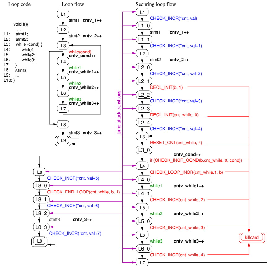
FIGURE 5.3 – Représentation compacte de TS pour une boucle
